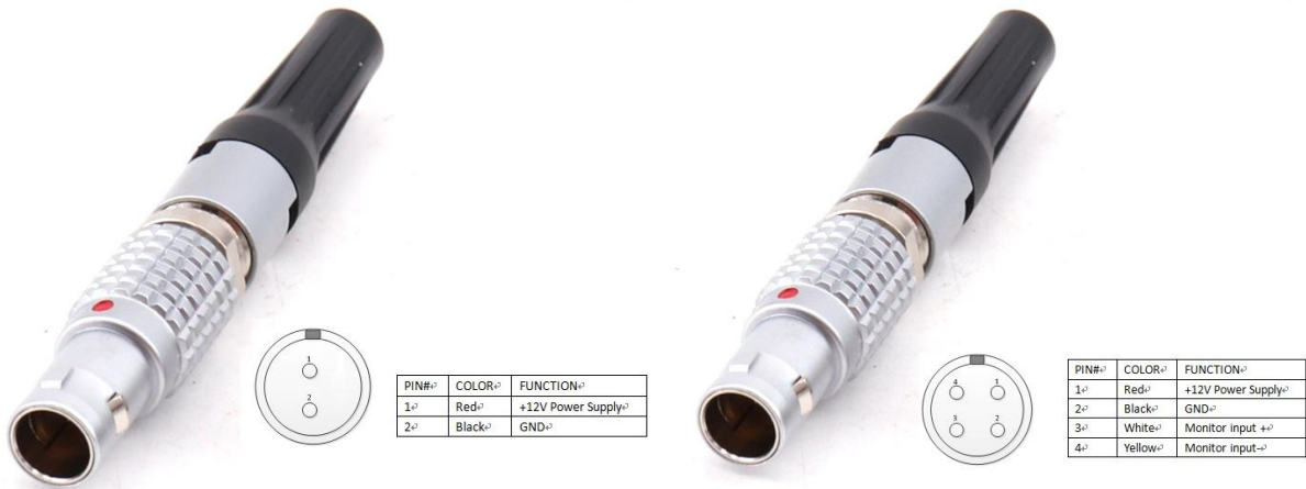
供电接口（不带监控输出与带监控输出）
