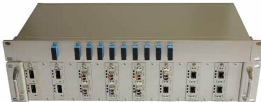
DWDM 密集波分复用设备是一种高速率、大容量波分复用传输系统，通道数量可达 48 波，单波道最高速率为 10Gbit/s，总容量达 480Gbit，可以最大程度地满足电信运营商超大容量和超长距离传输的需求，是目前应对光缆资源紧张的最佳解决方案。
