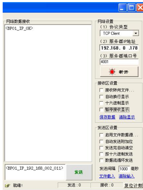
网络调试助手更改设备 IP 示意图
