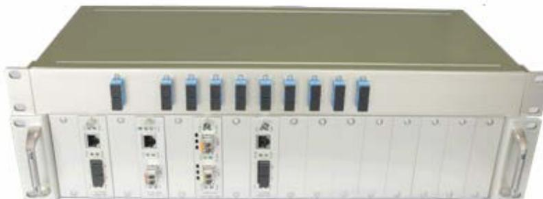
CWDM 粗波分复用设备结合城域网带宽需求高，传输距离短的特点，可运用于 G.652、G.653、G.655 光纤传输系统，该设备采用 2U+1U 架构，模块化设计，升级扩容方便；它延续了密集波分复用高带宽的技术优势，同时具有多业务接口、成本低、功耗低、体积小等诸多优点，使其在城域光网络中具有非常广阔的应用前景。
